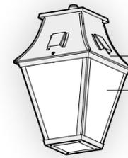
Assemblage en tôlerie soudée par points
